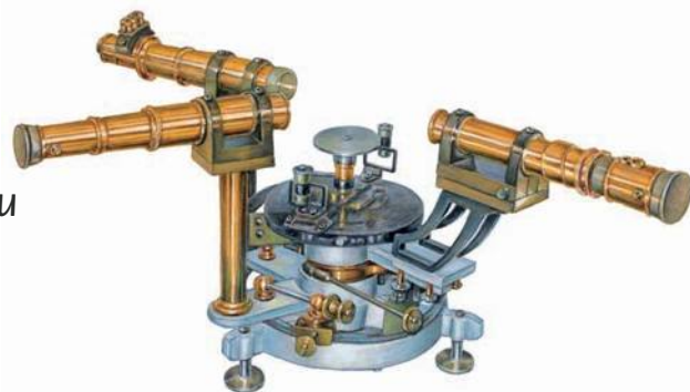
Спектроскоп, изобретенный в XIX в., позволил наблюдать спектры излучения звезд
